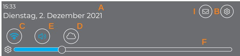
**A:** Uhrzeit und Datum werden angezeigt. Dieser Zeitstempel wird auch beim Speichern der Testergebnisse verwendet. Achten Sie daher auf die korrekte Einstellung von Datum und Uhrzeit.
